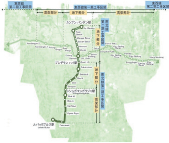
施工区間（15.7 km）
