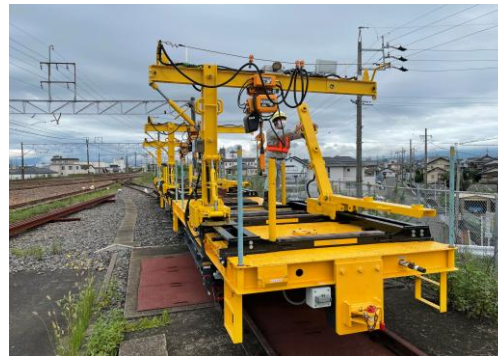
多目的の両側レール積卸機
