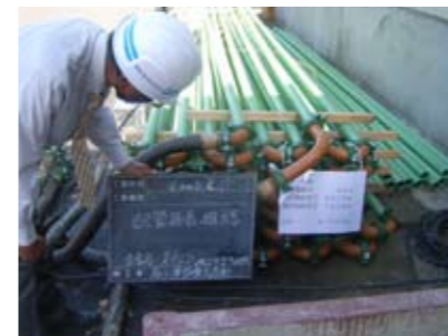
超長距離配合グラウト材・材料試験 圧送距離4km、1.5 N/mm 2
