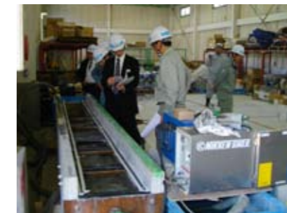
高耐水性配合グラウト材・材料試験 圧送距離3km、1.5 N/mm 2
