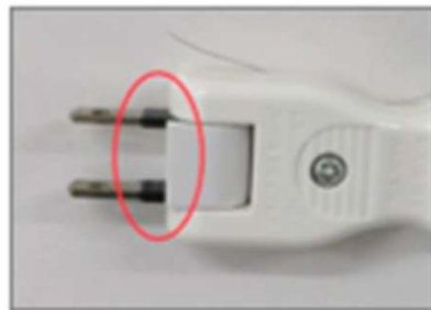
トラッキング 防止材取付状況
